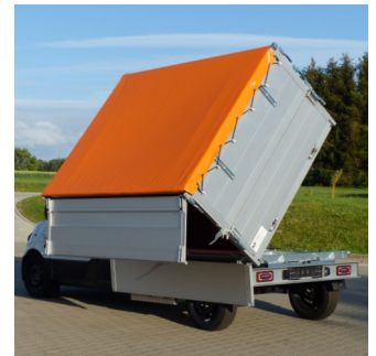
Seitliche obere Klappen pendelnd, untere Klappe abklappbar zum seitlichen entleeren
