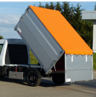
Verbundene hintere, obere und untere Klappe pendelnd zum entleeren
