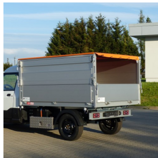
Hintere obere Klappe abnehmbar für das Häckseln
