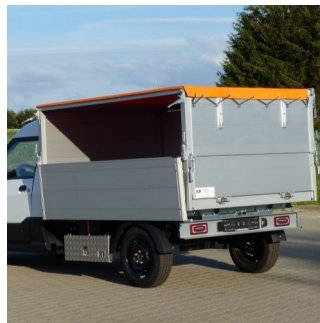
Seitliche obere Klappe, abklappbar für Müllsammlung
