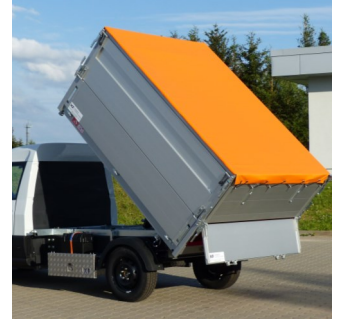
Hintere, untere Klappe pendelnd zum entleeren
