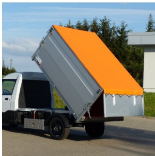
Hintere obere Klappe pendelnd, untere Klappe abklappbar
