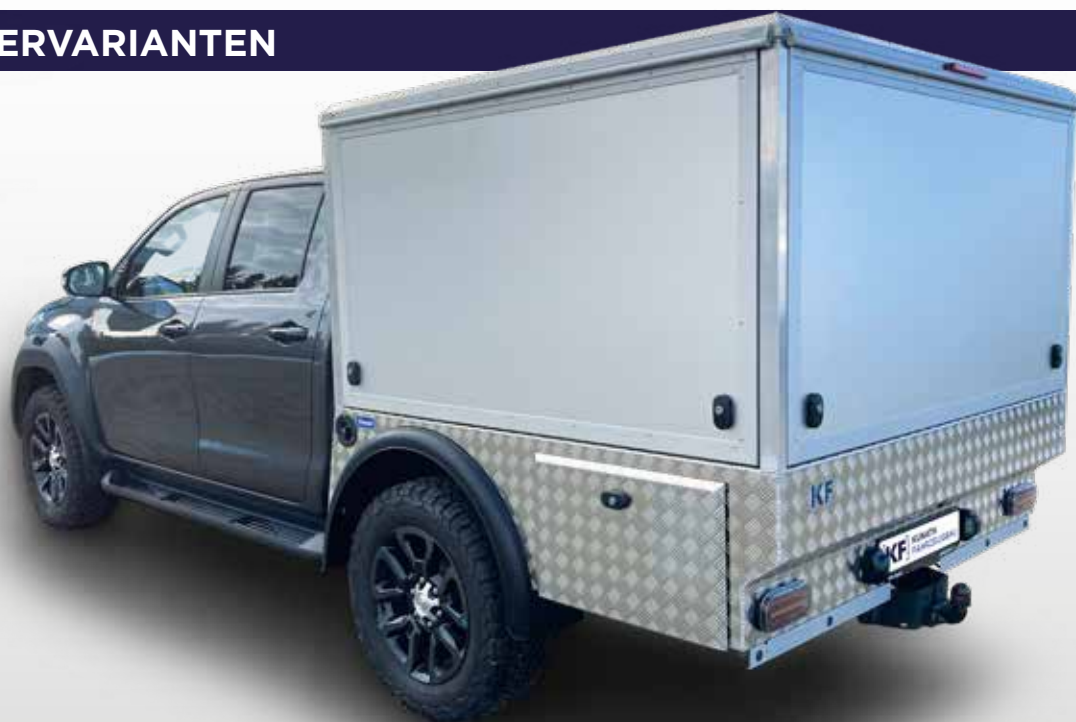
Toyota Hilux mit Systemkofferaufbau
