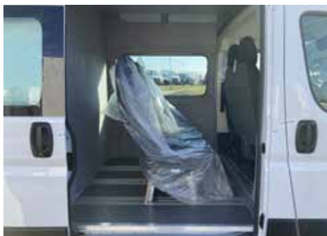
Trennwand hinter der zweiten Sitzreihe
