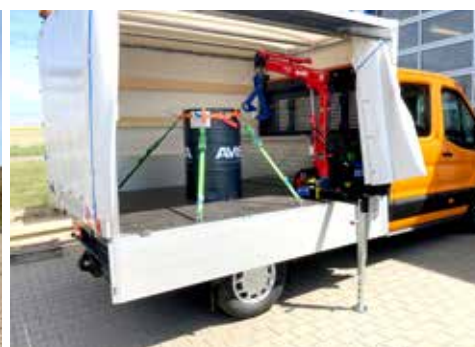
Pritsche mit speziellem Ladekran
