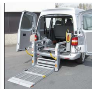
S957 Faltbare Plattform für Verringerung der erforderlichen Montagehöhe und für maximale Sicht des Fahrers durch Hecktüren
