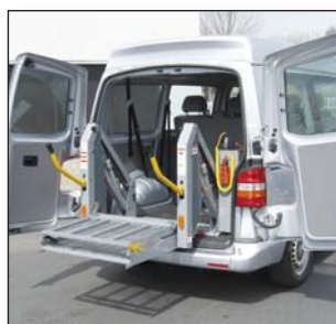
S957 Faltbare Plattform für Verringerung der erforderlichen Montagehöhe und für maximale Sicht des Fahrers durch Hecktüren
