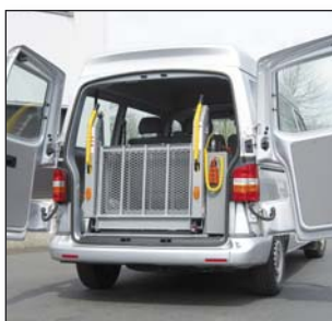
S957 Faltbare Plattform für Verringerung der erforderlichen Montagehöhe und für maximale Sicht des Fahrers durch Hecktüren
