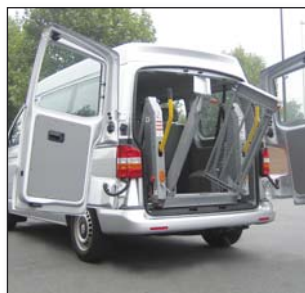
S953 Vertikal faltende Plattform für freien Durchgang ins Fahrzeug
