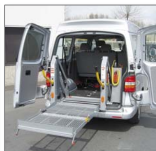
S957 Faltbare Plattform für Verringerung der erforderlichen Montagehöhe und für maximale Sicht des Fahrers durch Hecktüren
