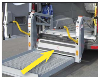
S955 Überfahrplatte montiert an Plattform
