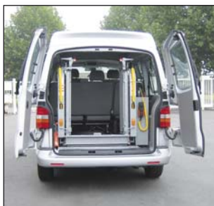
S953 Vertikal faltende Plattform für freien Durchgang ins Fahrzeug
